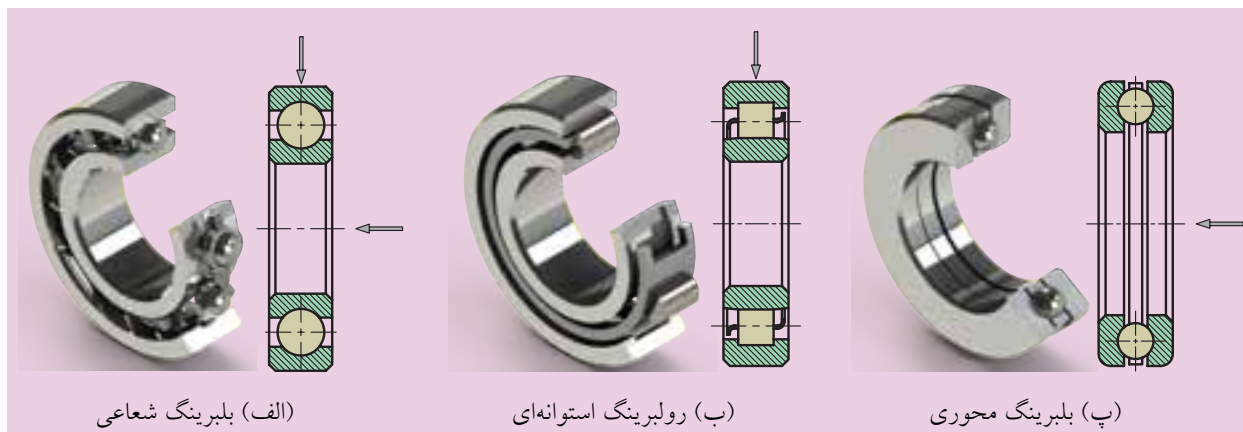
شکل ۶-۲۷ انواع یاتاقان‌های غلتشی
