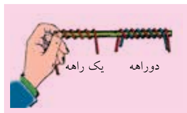
(ب) تشکیل پیچ یک‌راهه و دوراهه
